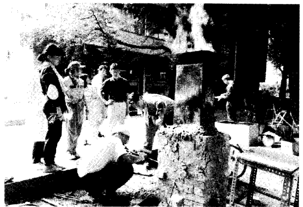
図1 小型たたら操業(下半分粘土、上半分鉄板の炉)
