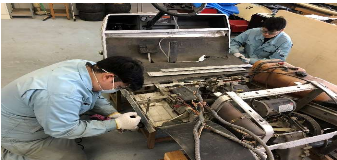
写真2 連携先から技術指導による車体加工
