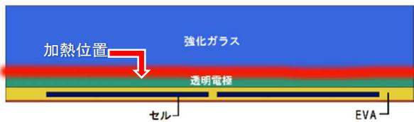
図 1 透明電極加熱型太陽電池モジュールの断面
