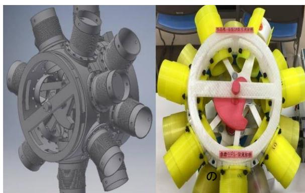
図3 星形14気筒エンジンのモデル
