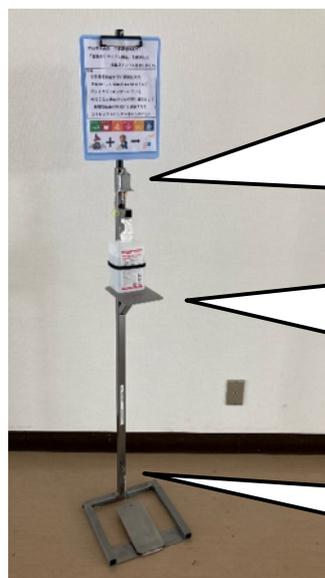
パワーウインドウモーターを使用！内部の磁石とコアの磁力を使い、下のペダルを持ち上げています！
