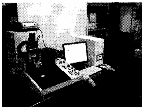
図5 卓上型 3 軸制御マイクロフライス盤
