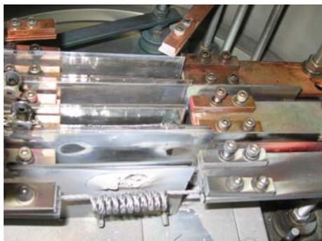
図5 真空蒸着装置内部
