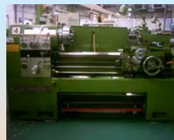
研修で使用した旋盤(池貝製)
