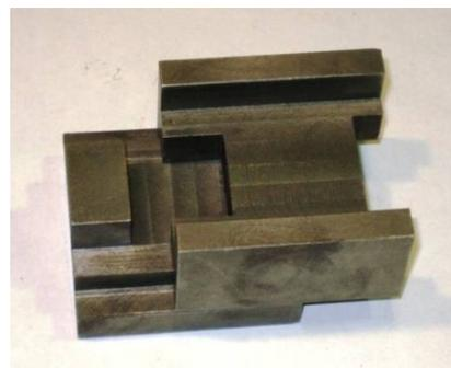
(図2) 2学年フライス盤実習教材 (鋳鉄)
