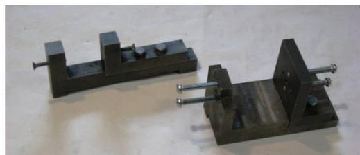
(図10) 考案した格子立方体用の治具(鋳鉄)
