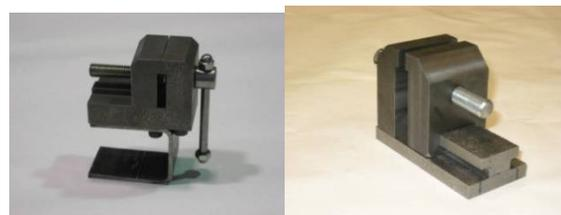
(図3) 小型万力 T型溝形式 (鋳鉄)
