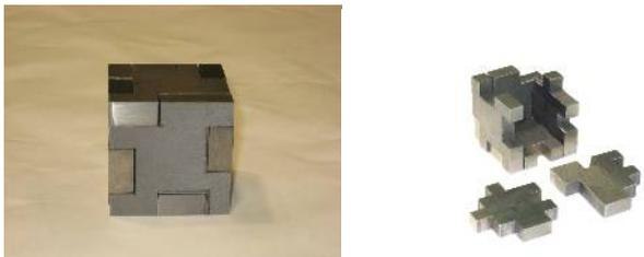
(図7) 6個組み立てブロック (鋳鉄)
