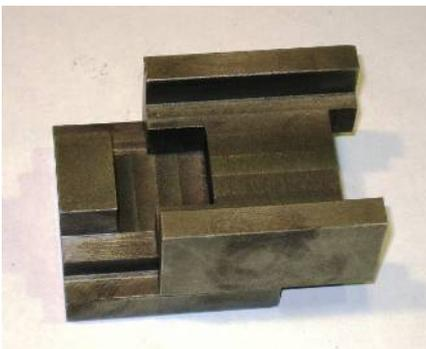
(図2) フライス盤実習教材（鋳鉄）
