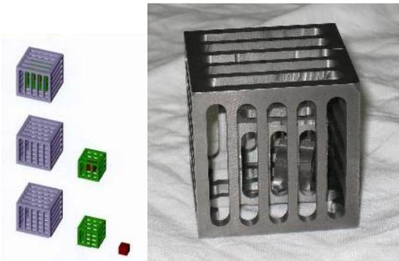
(図 26) 考案した格子立方体用の治具 (鋳鉄)
