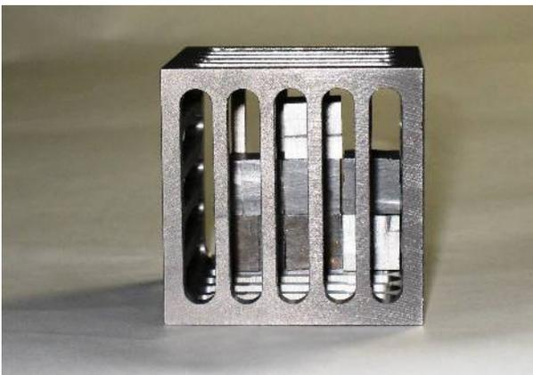
(図 27) 檻の中に7個の立方体を加工
