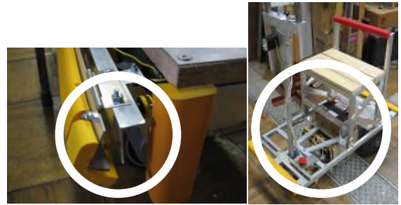
図9 二重衝撃吸収機構と車体構造 (コンパクト3輪カー)
