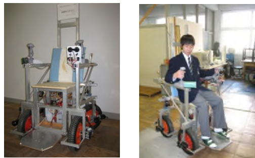
図1 平成20年度 生徒製作作品 T社のi-UNITのようなものを目指した「四輪独立駆動式小型電気自動車」
