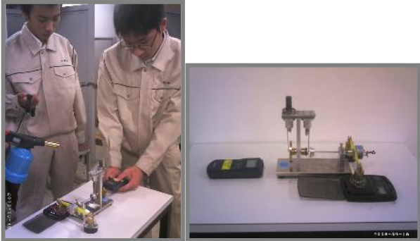
写真3 模型スターリングエンジンの効率測定実験
