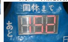
1セグメントにつき30個 合計630個のLEDを使用
