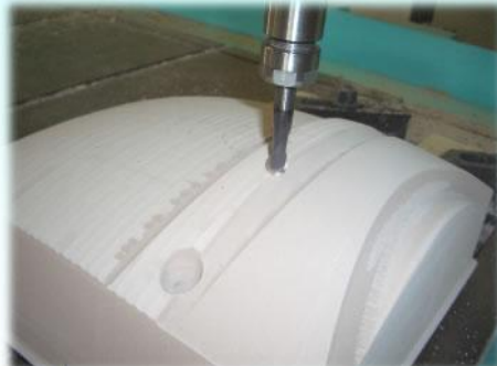
フロント部の切削
