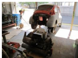
図 エンジンの取り外し
