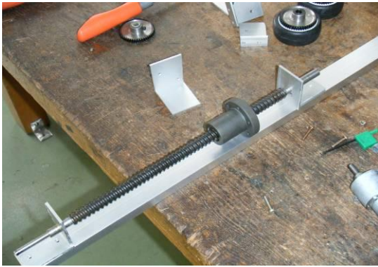
図 20 パンダジャッキー用大型ウォームギヤ
