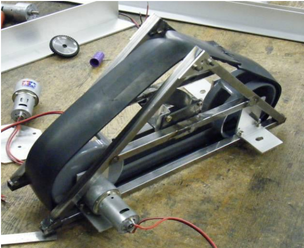
図 21 ベルト形クローラーの取付け
