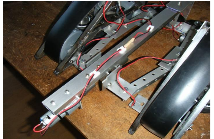
b) 本体中央部横幅変形機構（パンダジャッキー）
