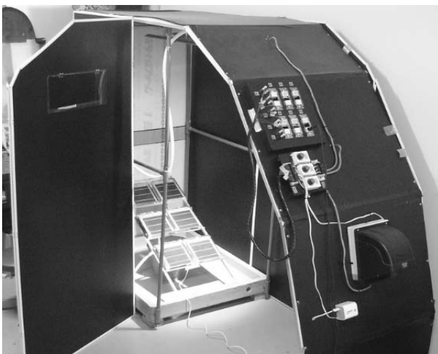
図1 太陽光発電実験装置の外観
