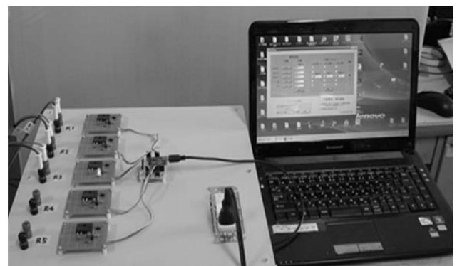
図2 パソコンによる照射時間の制御
