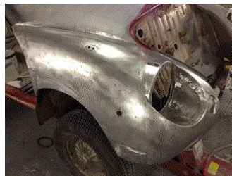
図4 古い塗装の剥離
