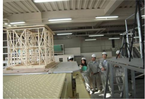
最新の加振装置での実験風景
